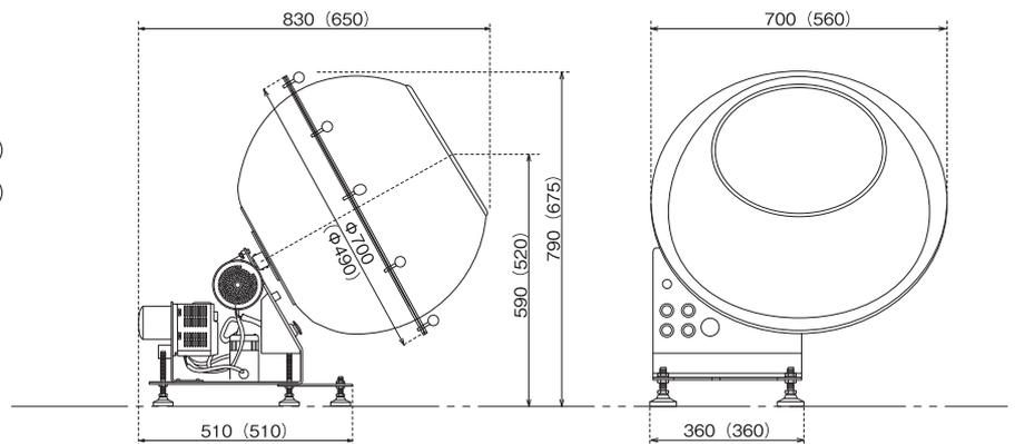
※パン内径φ600mmの図面になります。 ※ ( ) の寸法はパン内径φ420mmの寸法になります。
